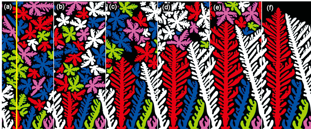
Fig. 13: Simulation results of CET under different critical nucleation undercooling degrees with G=40 \text{ K}\cdot\text{mm}^{-1} and V_p=250 \text{ }\mu\text{m}\cdot\text{s}^{-1} : (a) \Delta T_n=4 \text{ K} ; (b) \Delta T_n=4.5 \text{ K} ; (c) \Delta T_n=5.5 \text{ K} ; (d) \Delta T_n=6 \text{ K} ; (e) \Delta T_n=6.5 \text{ K} ; (f) \Delta T_n=8 \text{ K}
