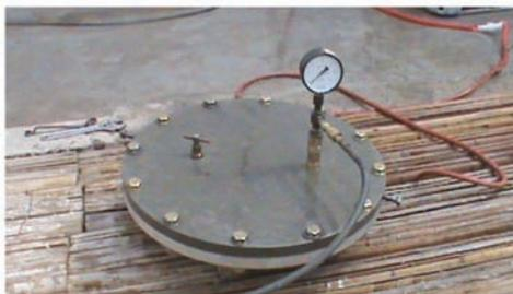
(a) 水压破坏试验装置
