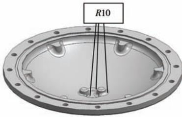
图6 优化壁厚减薄模型
