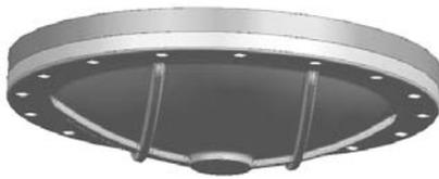
图2 水压破坏试验模型
