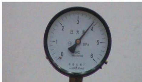
(b) 水压破坏试验压力示数
