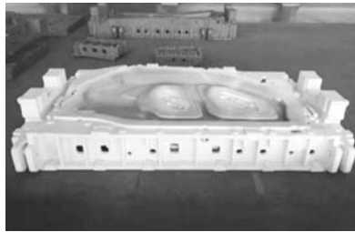
图1 钇基重稀土球化包芯线生产的GGG70L汽车模具
