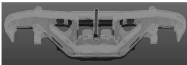
图5 侧架铸件充型过程数值模拟结果（充型33%）
