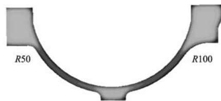
图4 缸体铸件圆角处优化
