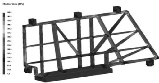
图4 型壳内冷却结束时的等效应力分布
