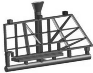
图1 钛合金骨架及浇注系统模型
