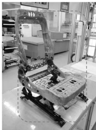
图12 完成装配的镁合金座椅
