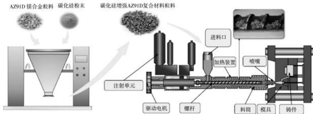
图1 镁基复合材料制备流程示意图
