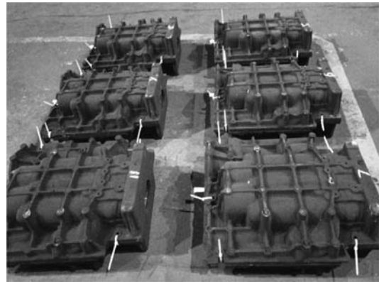
图6 壳型 Fig. 6 Shell mold
