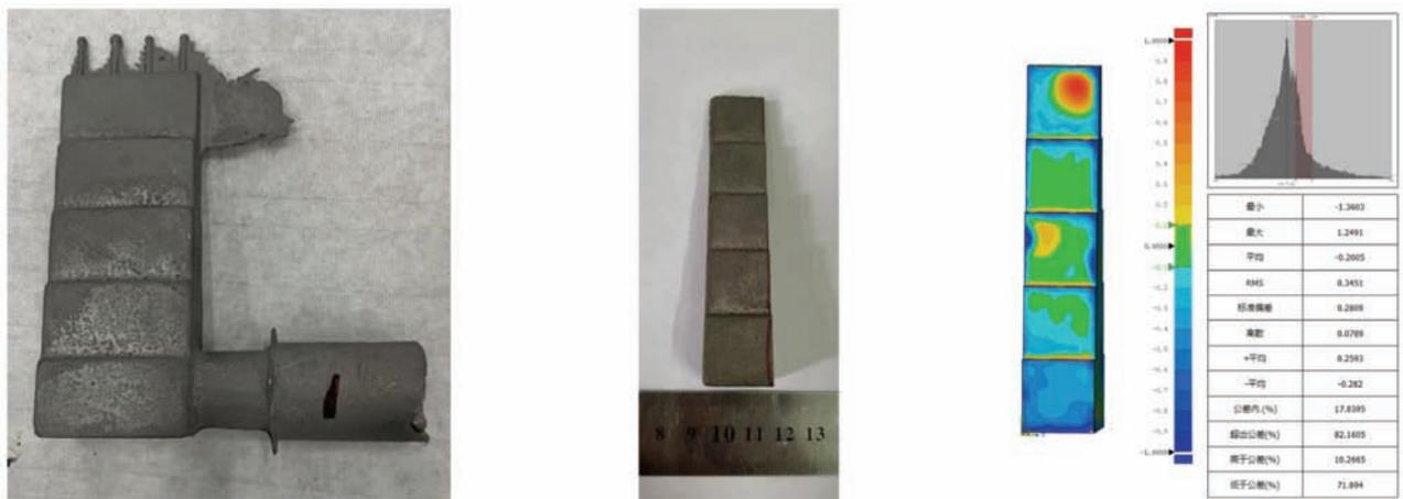
(a) 钛合金铸件 (b) 去除浇道后的一半阶梯钛合金铸件 (c) 一半阶梯钛合金铸件的尺寸对比结果图
