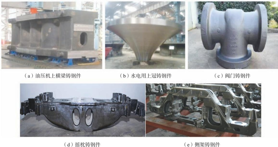
图3 新型酯硬化水玻璃砂工艺生产的典型铸钢件
