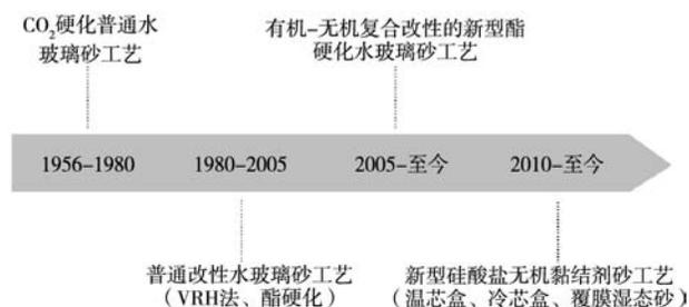
图1 硅酸盐无机黏结剂砂的发展历程
