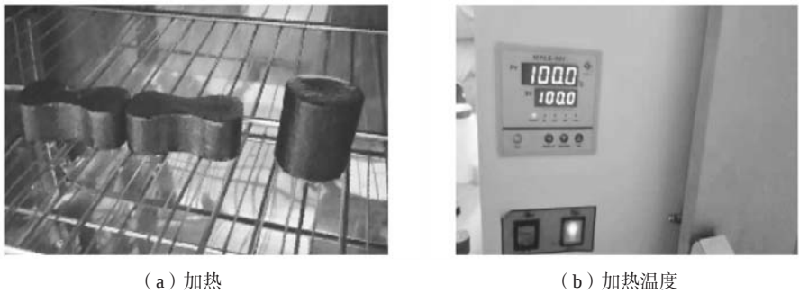
图2 耐热性测试 Fig. 2 Heat resistance test
