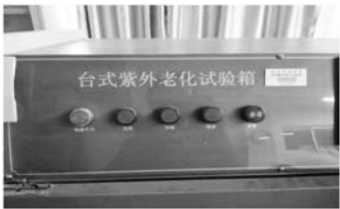
图5 台式紫外老化试验箱 Fig. 5 Desktop UV aging test box
