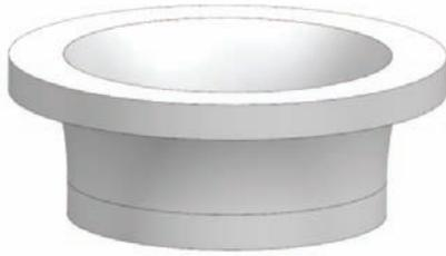
图1 外壳体毛坯3D模型
