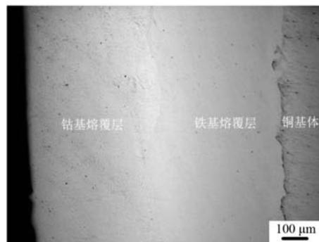
图3 梯度熔覆层横截面形貌
