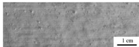
图2 钴基熔覆层表面无损探伤
