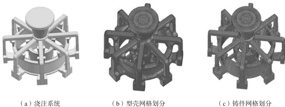
图2 排气机匣浇注系统与网格划分
