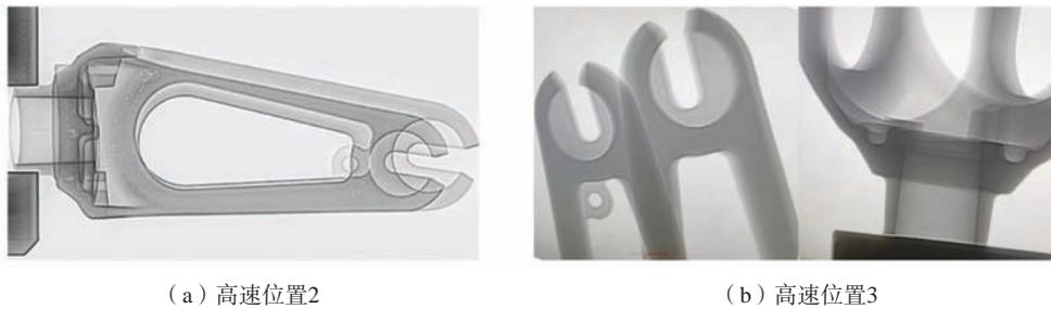
图8 前叉压铸件X射线探伤图
