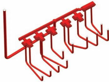
图2 6 MW风电主机架浇注系统模型(单侧)
