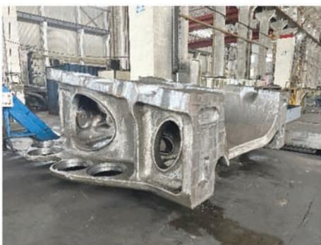
图14 6 MW风电主机架铸件
