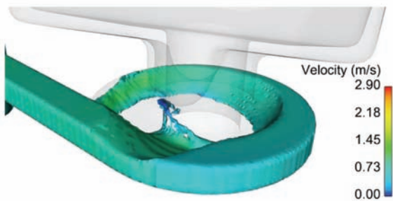
图10 充型初始阶段的局部紊流现象
