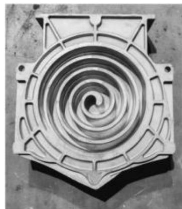
图16 T6热处理后的铸件 Fig. 16 Casting after T6 heat treatment
