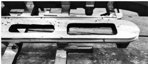
图6 导轨铸件试加工缺陷
