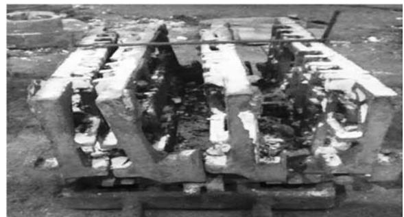
图12 导轨铸件热处理摆放方式及工装
