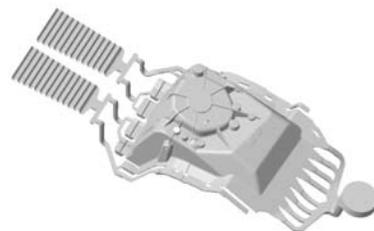
图4 浇注系统示意图
