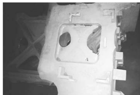
图6 铸件气孔缺陷放大照片
