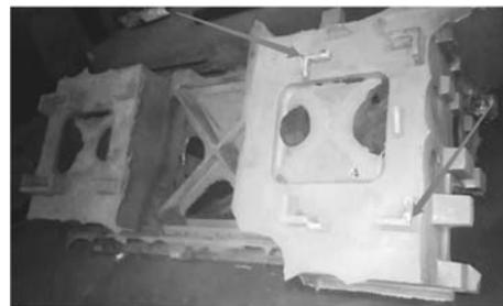
图5 铸件气孔缺陷照片
