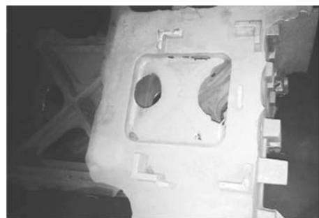
图6 铸件气孔缺陷放大照片
