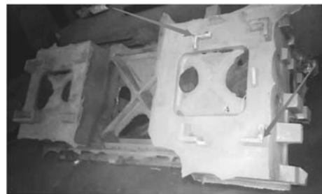
图5 铸件气孔缺陷照片
