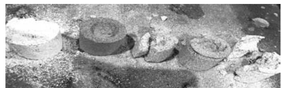
图2 试样1 600 °C灼烧10 min后随炉冷却取出用硬物划拨之后的情况(按试验编号从左至右排列)
