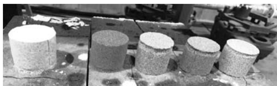
图1 试样1 600 °C保持10 min并随炉冷却取出后的情况(按试验编号从左至右排列)
