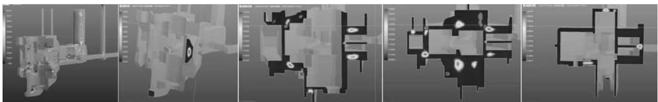
(a) 孤立液相区 (b) 截面1缩孔 (c) 截面2缩孔 (d) 截面3缩孔 (e) 截面4缩孔
