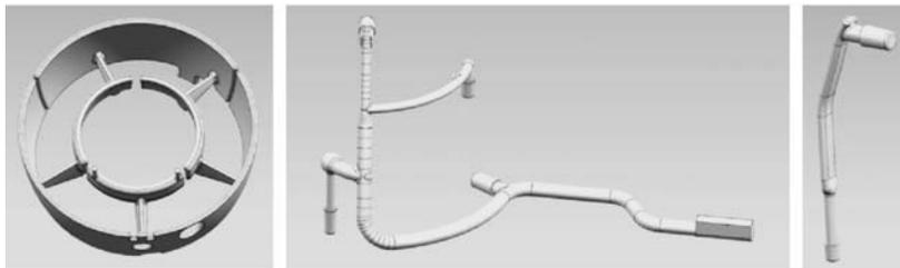
图2 某机匣铸件的大尺寸薄壁砂芯和细长管路的砂芯
