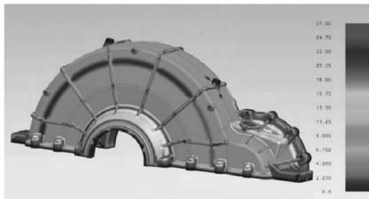
图2 铸件壁厚
