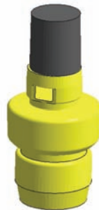
图3 发热冒口套与砂芯连接结构的三维图
