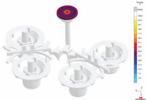
图7 改进工艺方案后铸件缩孔缩松缺陷预测结果
