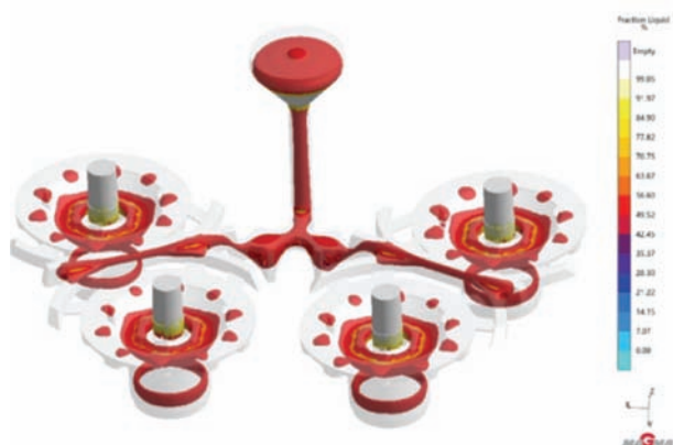
图5 铸件凝固后期的孤立液相区预测
