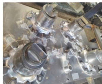
图8 改进后的下模型板
