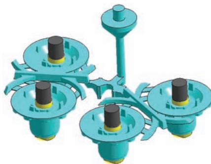
图4 轮毂铸件的初始浇冒口工艺
