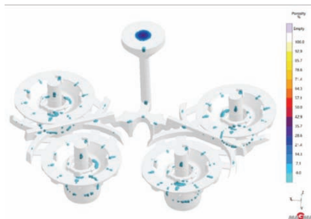
图6 铸件缩孔缩松缺陷预测
