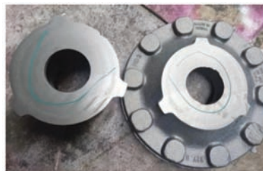
图11 轮毂铸件第一道轴承连接处截面上有缩松缺陷
