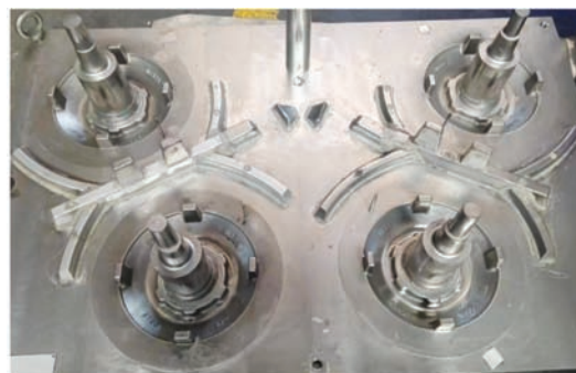
图9 改进后的上模型板
