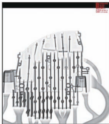
图12 X射线无损探伤结果
