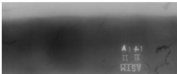
图3 管路开裂部位X射线检测结果
