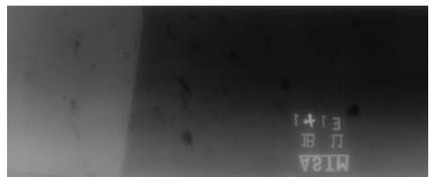
图4 管路完好部位X射线检测结果
