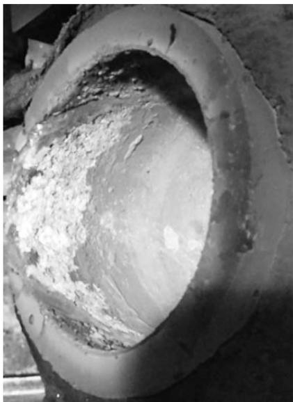
图8 使用后的真空感应熔炼坩埚
