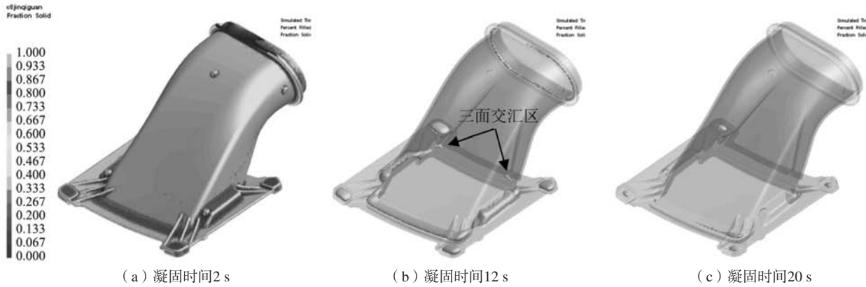
图2 无浇注系统凝固模拟结果
