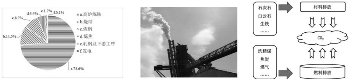
(a) 钢铁工业各工序CO 2 排放所占比重 (b) 宝钢调研实际碳排放(2021年7月底) (c) “燃料”与“材料”排放示意图
