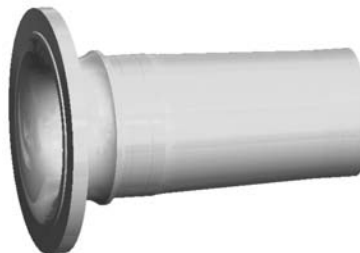
图1 某大功率风力发电机组的主轴模型 Fig. 1 Model of a high power wind turbine spindle
