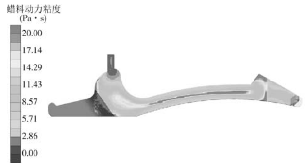
图7 充型末期蜡料粘度分布模拟结果
