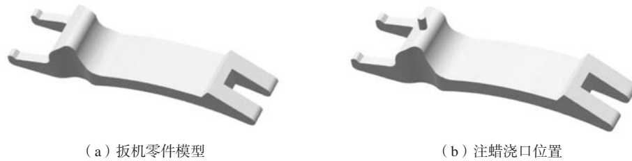
图4 扳机零件及浇口位置几何模型
