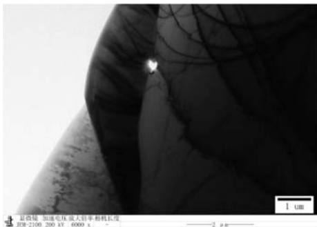
图2 1 060 ℃热处理产生的析出相形貌
