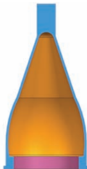
图2 锥体铸件示意图
