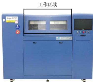
图7 砂型3D打印机及工作区域内部结构
