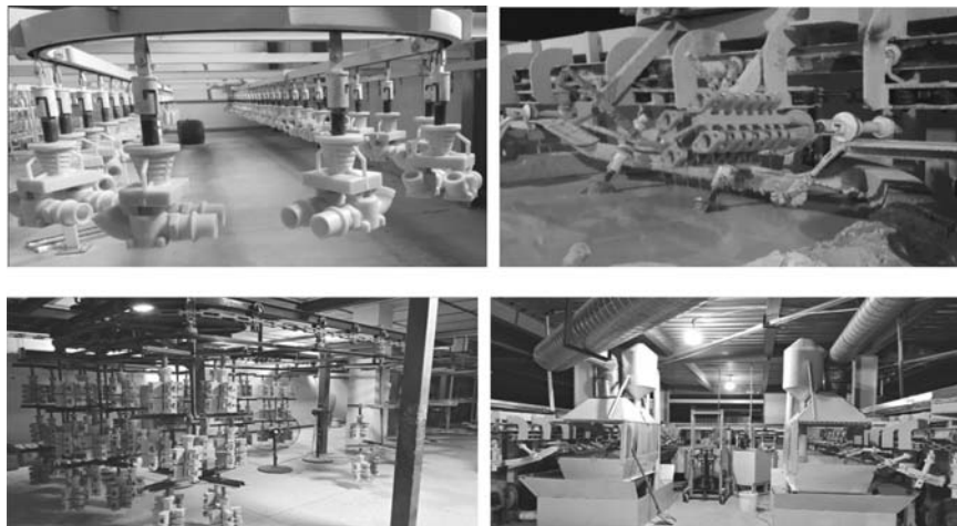
图10 硅溶胶快速制壳生产线
