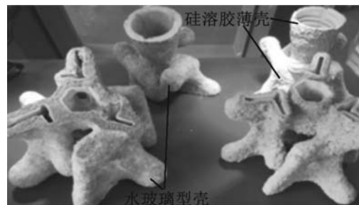
图6 水玻璃型壳与硅溶胶薄壳对比 Fig. 6 Comparison of sodium silicate shell and silica sol shell
