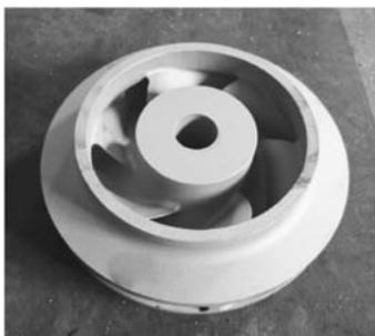
图6 合金叶轮铸件
