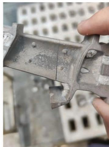
(b) 叶片实际断裂位置
