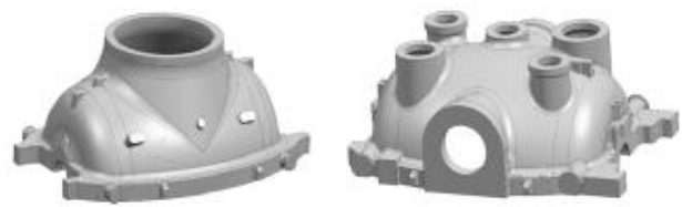
(a) 中压外缸上半
