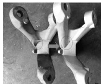
图3 零件增大补缩通道的实例图
