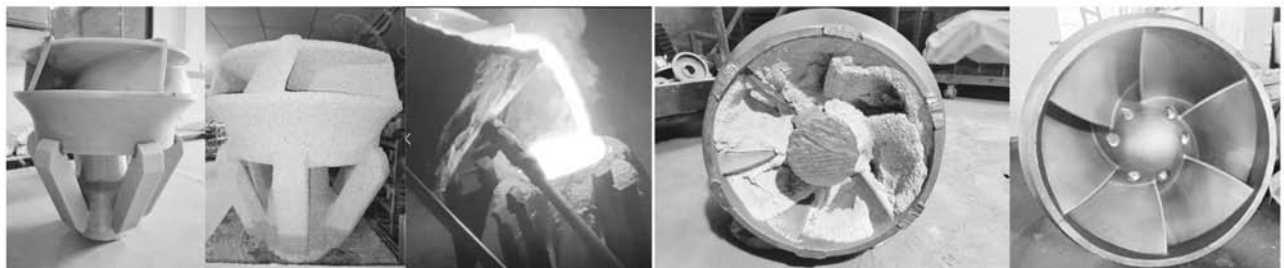
(a) 组树 (b) 制壳 (c) 浇注 (d) 切割打磨 (e) 铸件成品
