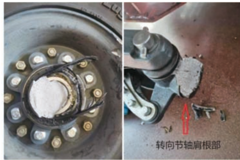
(b) 右侧转向节轴肩根部断裂
