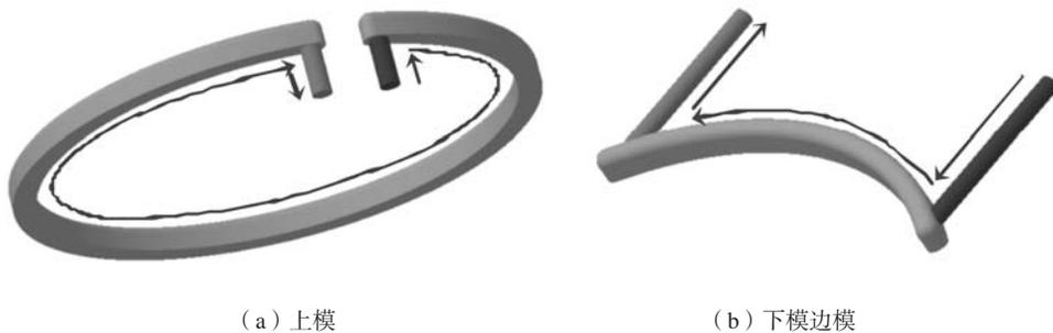
图5 水冷通道设计方案示意图
