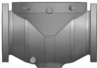
图1 CE3MN双相不锈钢球阀铸件图
