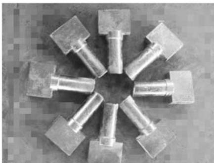
图7 浇注后的铸件
