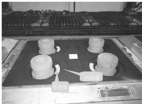
图5 内浇道经过外冷铁
