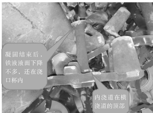
图2 造型线造型的浇注系统
