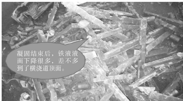
图1 摆地摊造型的浇注系统
