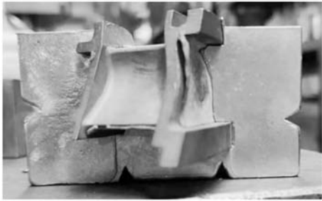
图15 导向器叶片与浇注加工基准实物图 Fig. 15 Guide and pouring machining benchmark
