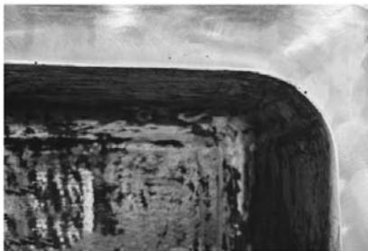
图4 气缸体的夹渣缺陷
